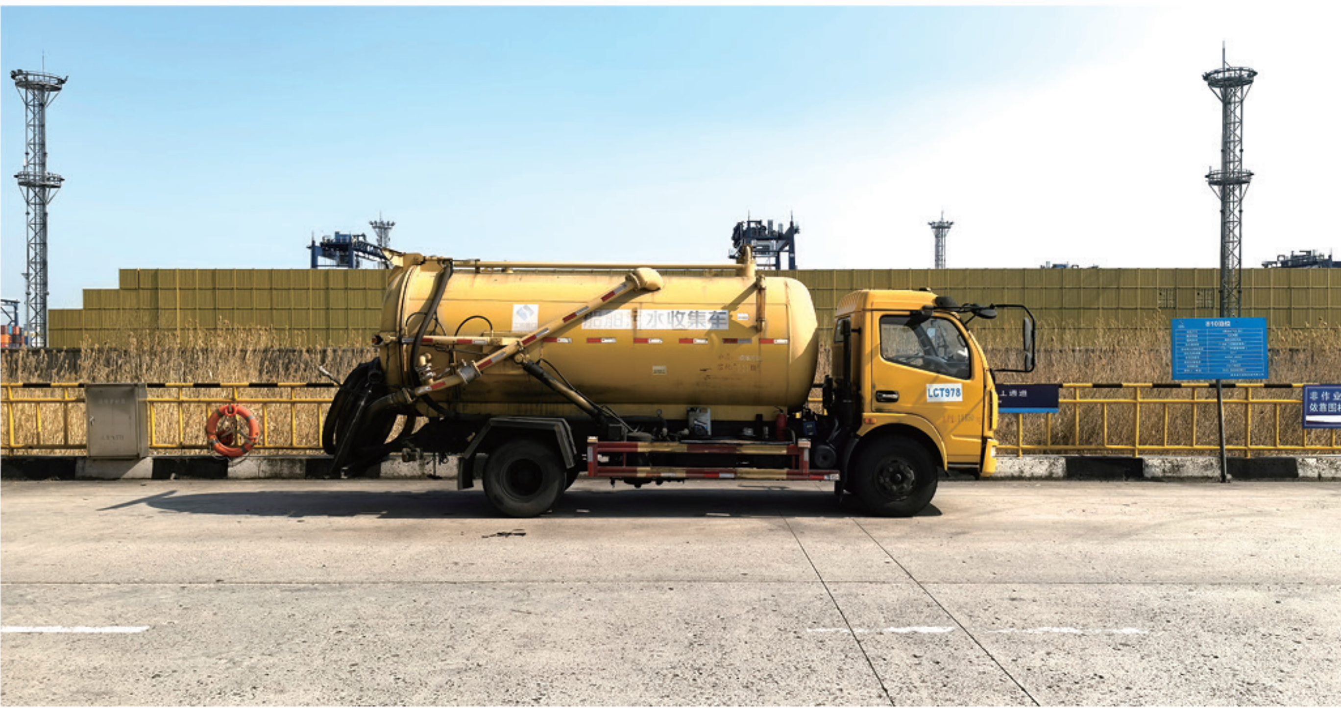
▲ 龙集公司码头船舶污水收集车
