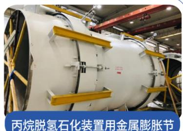
丙烷脱氢石化装置用金属膨胀节
