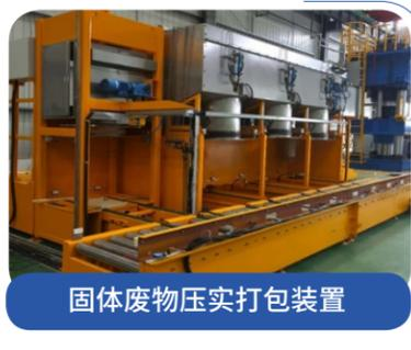
固体废物压实打包装置
