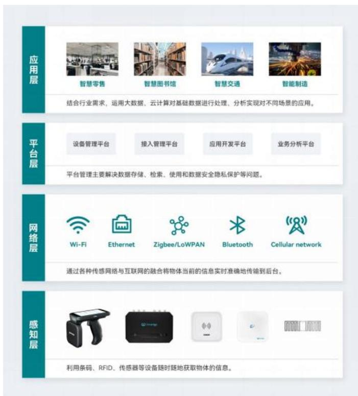
感知层：也称为数据感知层，通过 RFID 及其它传感技术实现“物”的感知和识别。由各种传感器以及传感器网关构成，包括二氧化碳浓度传感器、温度传感器、湿度传感器、二维码标签、RFID 标签和读写器、摄像头、GPS 等传感终端。
