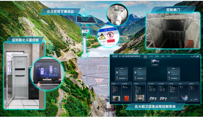
“水电站大坝北斗安全监测及应急远程控制系统”开发了适合高库大坝的北斗融合静态高精度解算算法,定位精度最优可达1毫米,满足高库大坝变形监测要求,对保障我国水电站大坝安全稳定运行具有重要意义。
