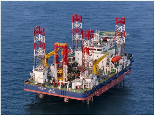
“80米级水深海上风电自升式综合勘测平台”是当前国内适用水深最大、升降速度最快、定位精度最高的海上风电综合勘测试验平台,对保障深远海风电工程的勘测设计和施工运维具有重要意义。
