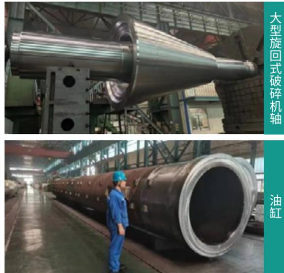
大型旋回式破碎机轴
