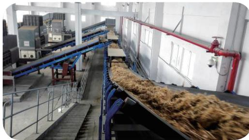
★输送系统中的生物质料(破碎后)
