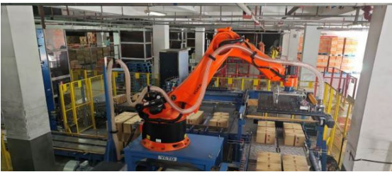
机器人码垛，在国内首次实现一台机器人负责两条线生产
