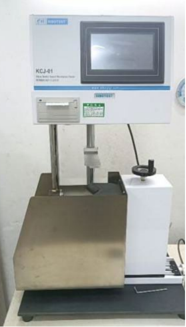
相关质量检测设备（玻璃抗机械冲击实验仪、气相色谱分析仪、双光源配色看版台）
