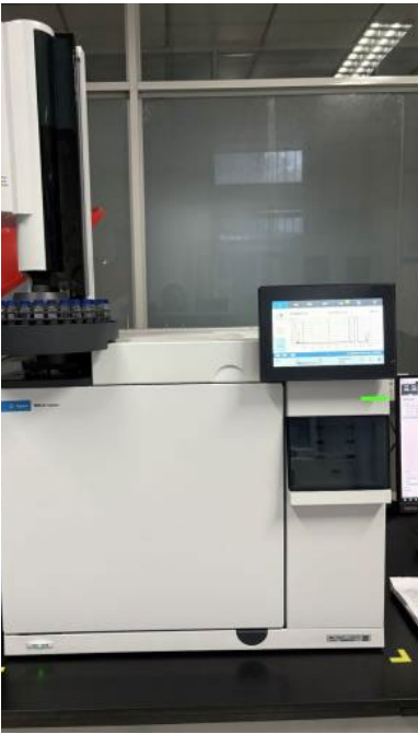
相关质量检测设备（玻璃抗机械冲击实验仪、气相色谱分析仪、双光源配色看版台）
