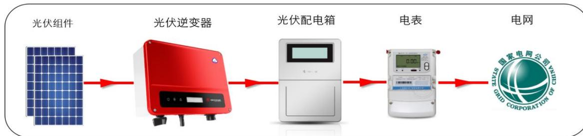
公司的光伏并网逆变器均为组串式逆变器。相较于集中式逆变器，组串式逆变器具有最大功率跟踪电压范围宽、转化效率高、组件配置灵活、性能安全可靠等特点，可满足户内、户外等不同的应用环境要求，目前已广泛应用于住宅、商业屋顶、农场、地面电站等光伏发电系统。经过多年的研发投入和积累，公司光伏并网逆变器产品种类齐全，组串式光伏并网逆变器已涵盖 0.7kW~320kW 功率范围，可以全面满足各种类型光伏组件和电网并网要求，稳定高效运行于高温、高海拔、风沙、盐雾、低温等各种自然环境。
