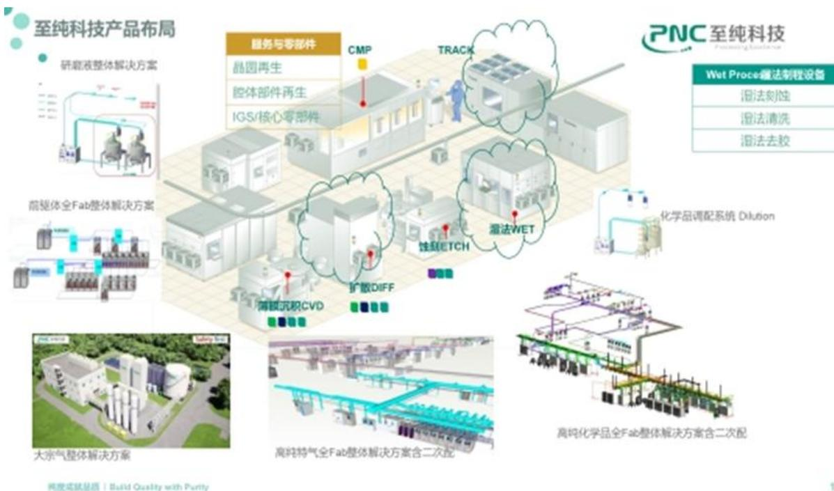
如图，可以看到高纯特气、大宗气系统均和薄膜沉积、干法刻蚀、扩散等工艺机台的腔体连成一个工作面，实现干法工艺目标；高纯化学品、化学品调配系统均和湿法工艺机台的腔体连成一个工作面，实现湿法工艺目标；前驱体系统、EPI 和 ALD 等工艺机台的腔体连成一个工作面，实现其工艺目标；研磨液系统和 CMP（化学机械抛光）机台连成一个工作面，实现研磨工艺目标。而在制程设备方面，公司重点布局了湿法设备，并在产品平台和工艺搭载上基本覆盖了全部湿法工艺。利用公司对于湿法设备、湿法工艺及配套气化设备及系统的优势，同时公司布局了相关材料及部件服务业务，以满足核心用户在生产运营周期中的需求。利用公司 20 多年在气体零部件及气路模块的优势，公司布局了支持设备的核心零部件业务，以满足核心终端用户及设备厂商的需求。公司在集成电路领域的布局，立足自身核心技术的优势，为公司长足发展奠定战略基础，力争能够穿越产业不同周期都有平稳营收。要成为一个穿越周期的好企业，都是从前瞻性的战略判断开始，然后持续构建实现这个战略的能力。公司正是基于整个决策层的战略眼光和安静务实的定力，践行这个认知。
