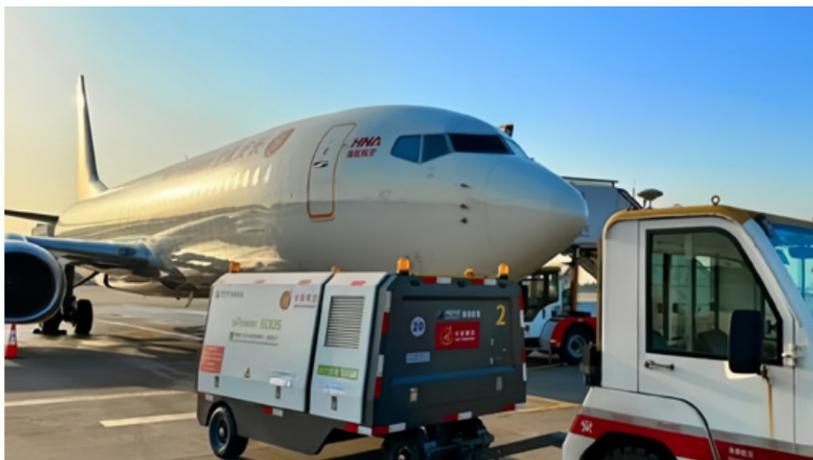
长安航空储能式电源车向飞机供电
