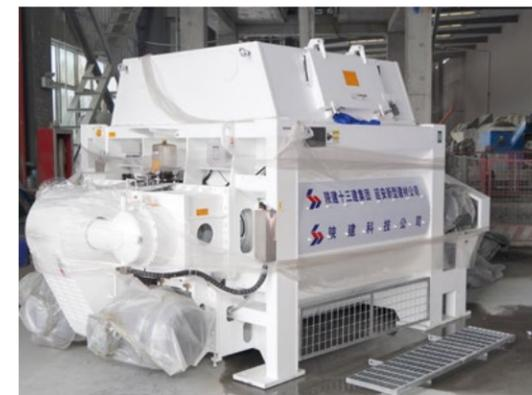
混凝土搅拌站和新型振动搅拌设备
