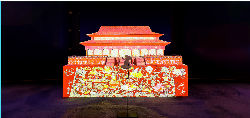
投影+AI实现快速自动完成拼融影像，利用传感器消除“小熊”遮挡阴影
