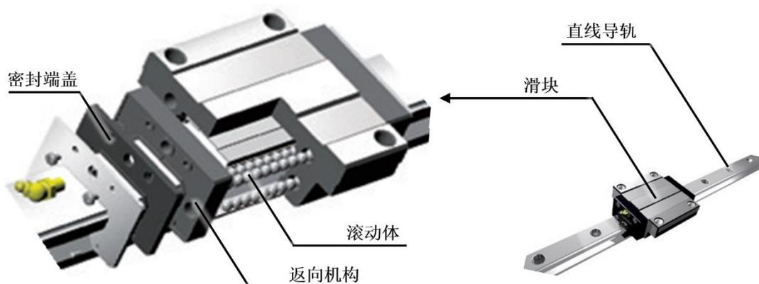
标的公司生产的滚动导轨副规格全面，导轨宽度覆盖 5~125mm、单根最大长度 6m，可实现大承载、高精度、高速度、低磨损、可靠性及标准化等优良特性。标的公司能够满足 1~5 级精度（我国标准，数字越小精度等级越高）滚动导轨副的批量化生产，单个滑块最大承载能力达 192 吨，60m/min 高速运行下噪音低至 59~64dB，主要关键指标国内领先，与国际先进水平一致。
