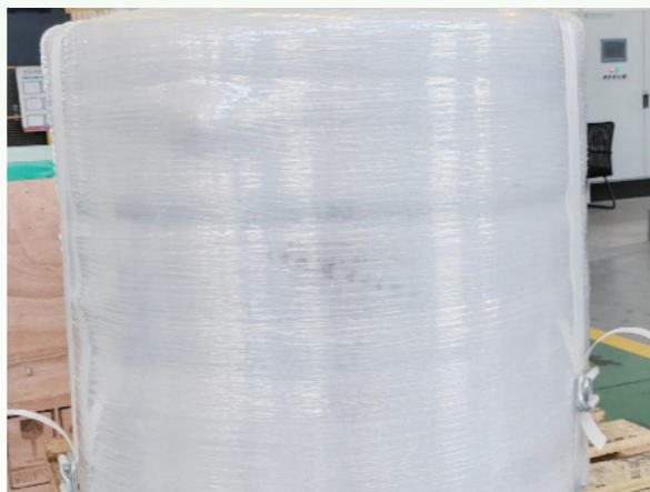
改良后, 使用托盘、防锈膜、打包带包装
