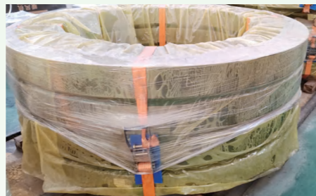
改良后, 使用托盘、防锈膜、打包带包装
