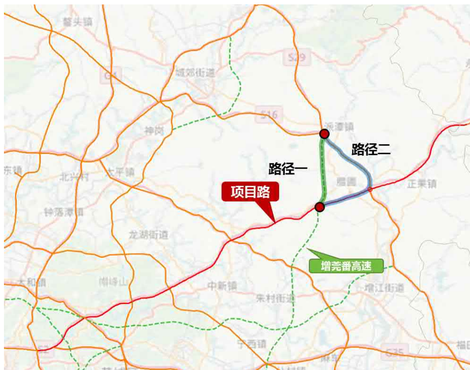
图 5-13 增莞番高速开通后分流路径示意图
