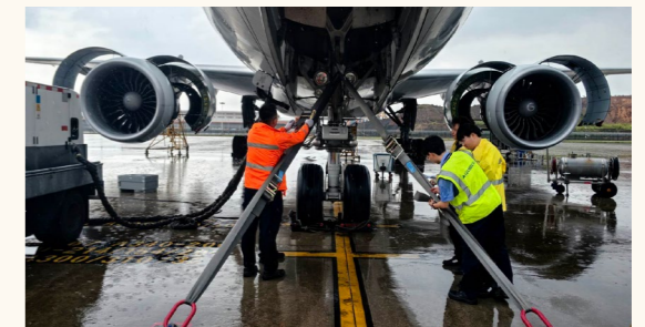
国货航机务维修工程部开展台风系留演练
