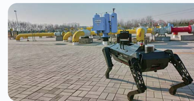
自主研发的防爆四足巡检机器人
