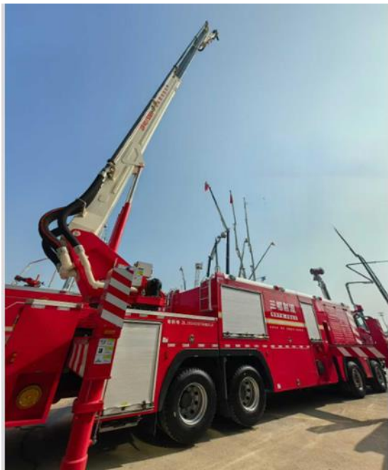
图 8 42m 大流量三相射流消防车
