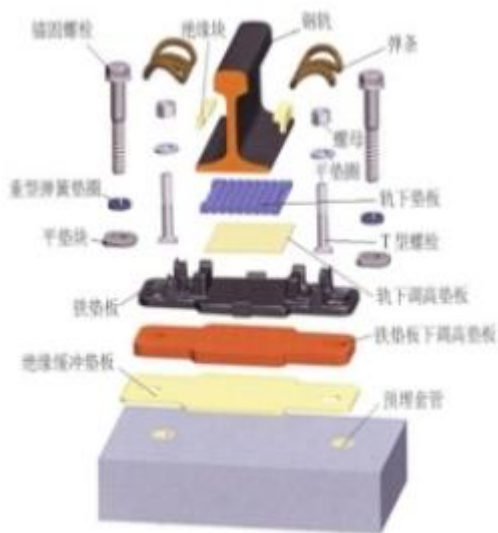
WJ-7型扣件组装零件图
