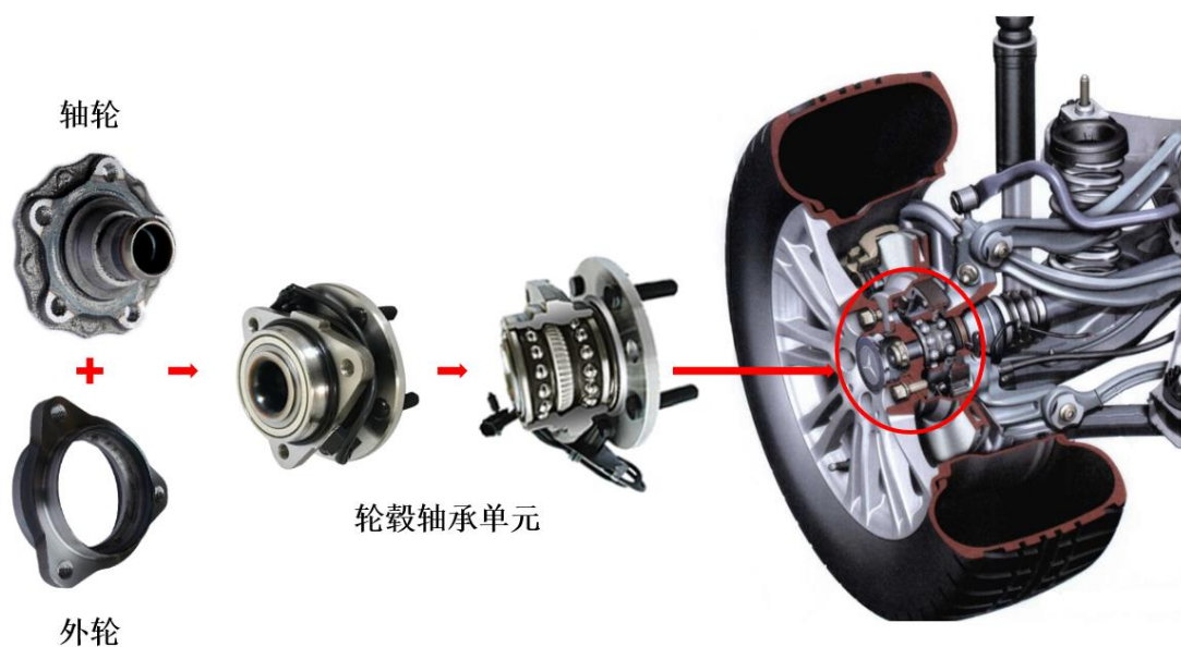
图：轮毂轴承单元在汽车中的位置示意图
