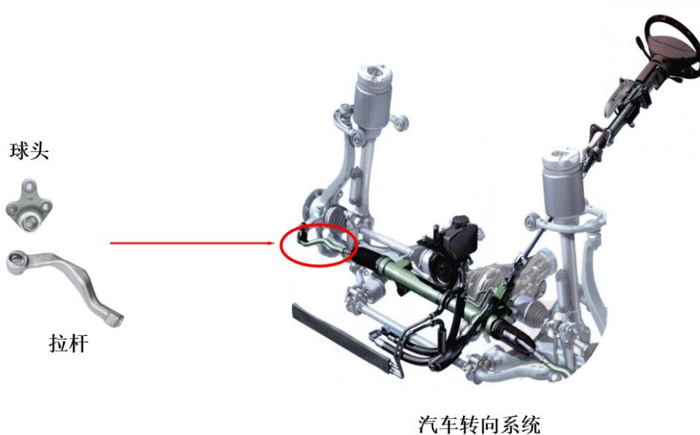
图：球头拉杆在汽车转向系统中的位置示意图
