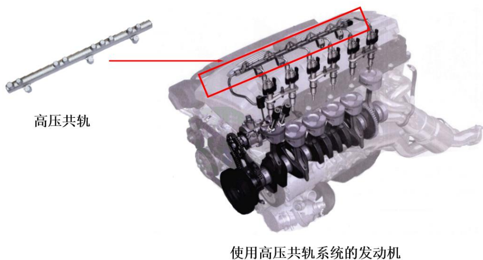
图：高压共轨在汽车发动机中的位置示意图
