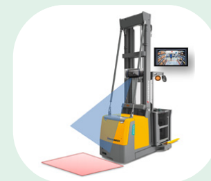
波蘭貝津(Będzin)和中國江門的叉車配備了攝影機，可通過實時人體檢測與物體識別實現基於AI的防撞功能
