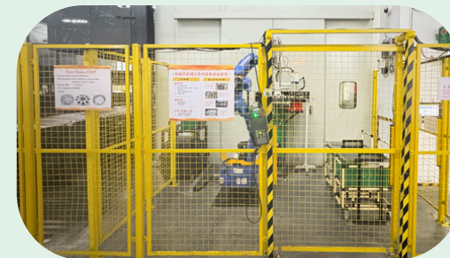
我們中國江門生產工廠啟用AI電子圍欄，以增強機械臂運行安全。
