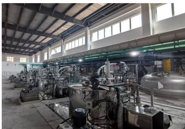
图：湖北荆州基地铍化合物生产线
