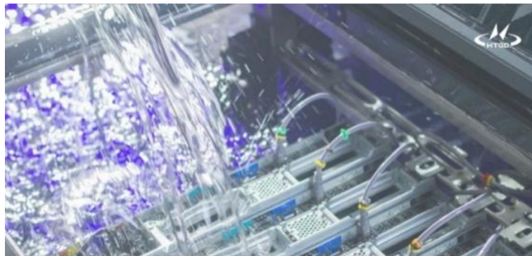
亨通浸没式液冷系统
